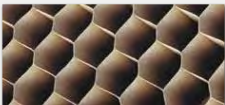
(A) Wkład stabilizujący „plaster miodu”
